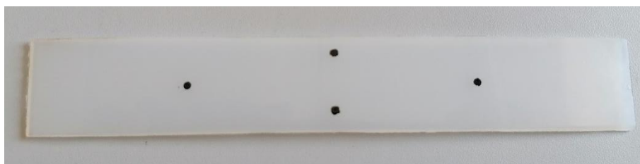
3.6. ábra. A Poisson-tényező mérésére használt próbatest
