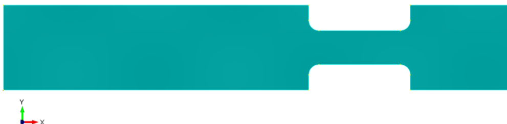
4.2. ábra. Két oldalt mart lemez geometriája
