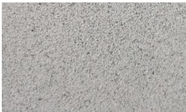
5.2. ábra. A próbatest vizsgált felületén elkészült sztochasztikus minta
