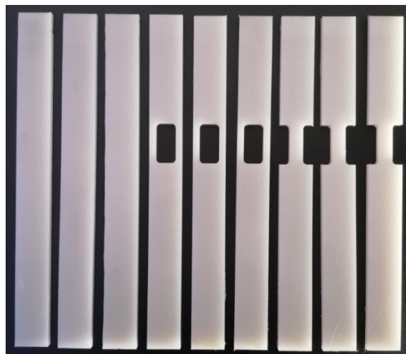
5.1. ábra. A PA6 anyagminőségű lemezből CNC marógéppel kimunkált próbatestek
