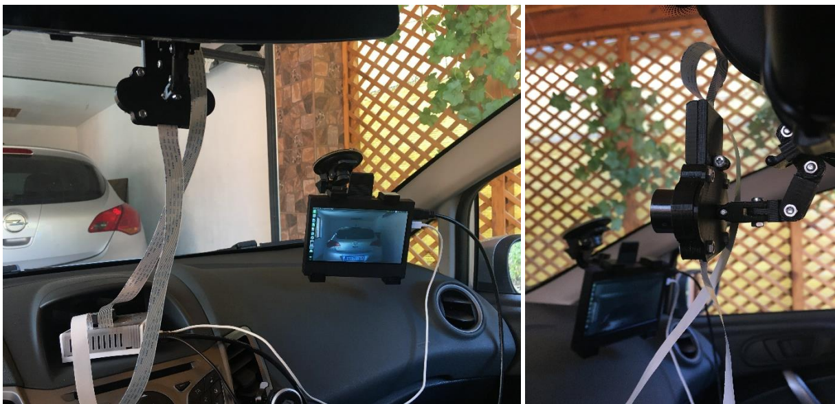
9. ábra: A rendszerben felhasznált eszközök beszerelve az autóba [saját ábra]
