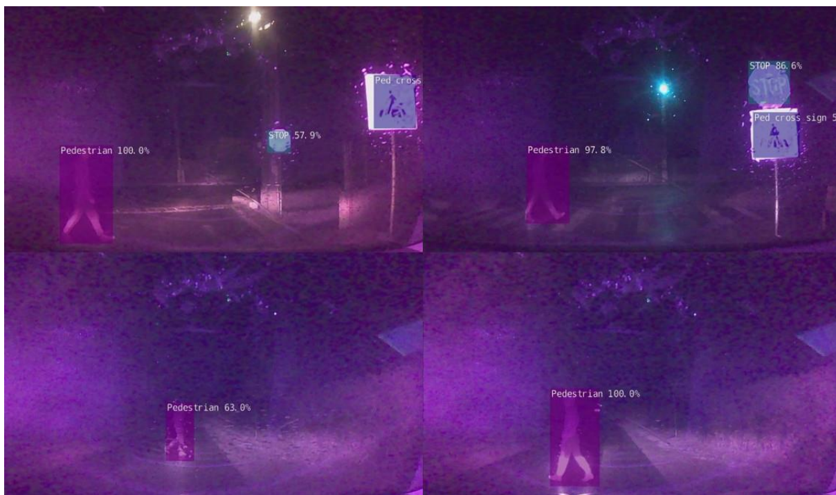
31. Gyalogosfelismerés tesztelése éjszaka, esőben [saját ábra]
