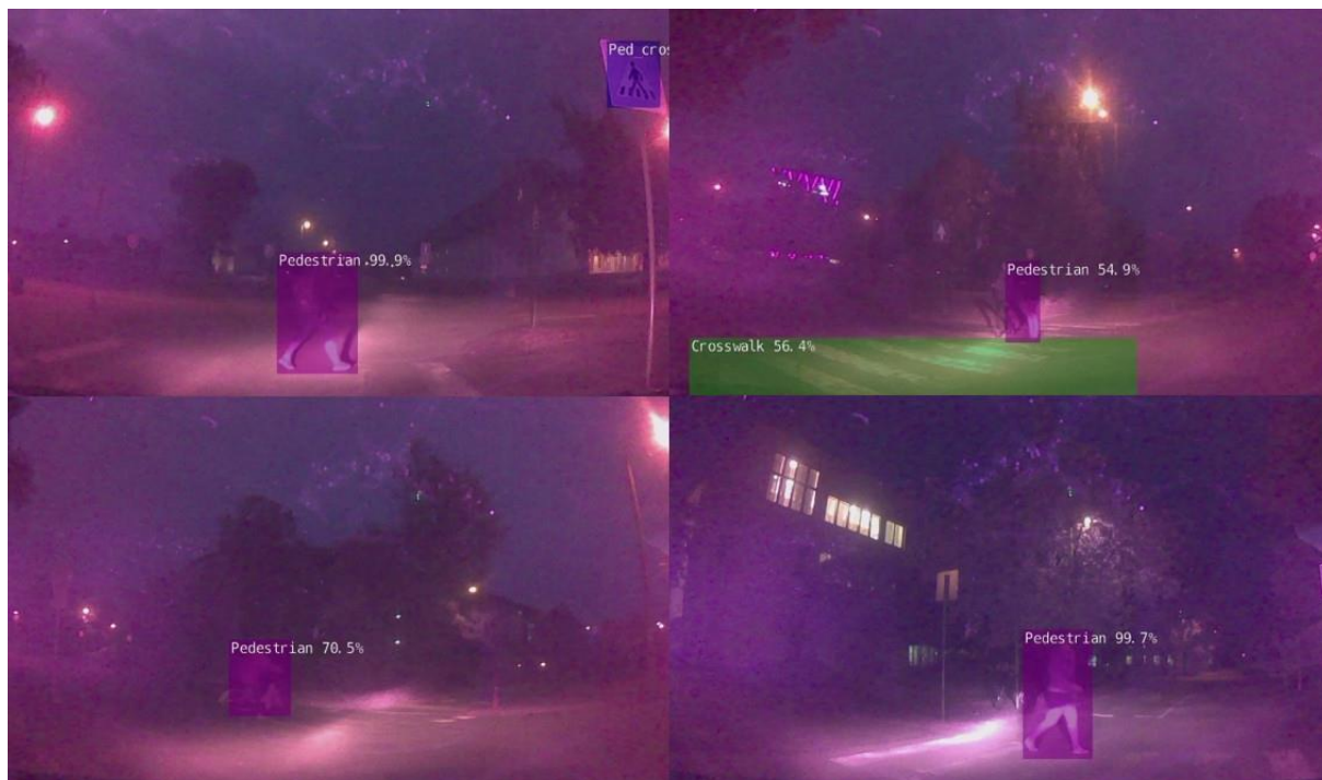
30. Gyalogosfelismerés tesztelése szürkületben, este [saját ábra]
