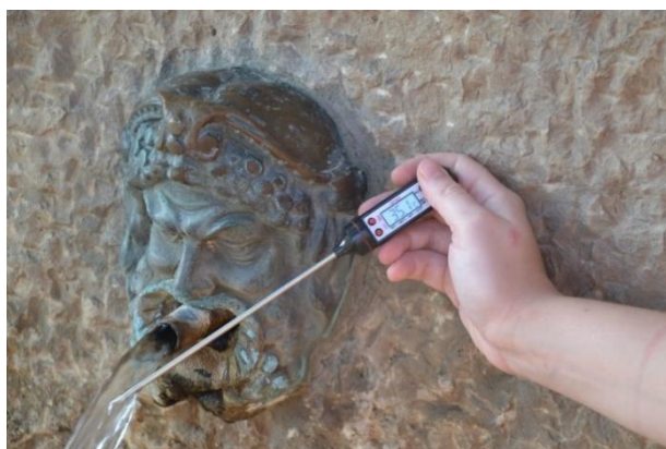
5. ábra Az Áldás víz hőmérsékletének mérése. Forrás: Saját
