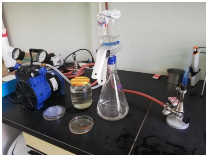
8. ábra A mikrobiológiai vizsgálatok során használt szűrőberendezés és a szűréshez szükséges eszközök. Forrás: Saját
