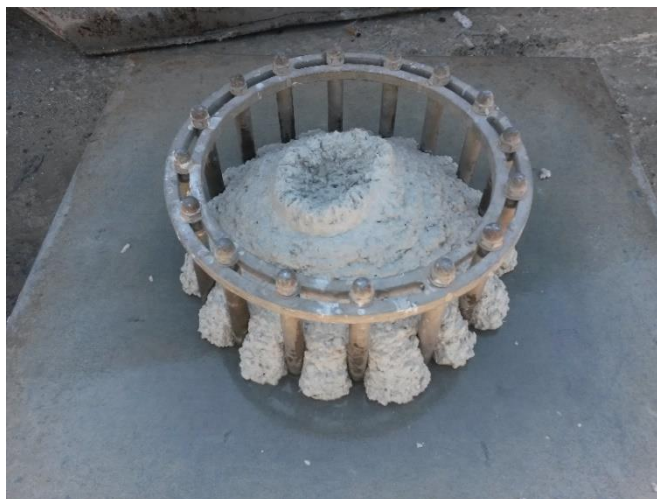
36. ábra: Fékező gyűrűs terület vizsgálat során a szétterülő öntömörödő beton
