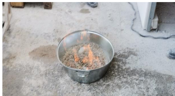
30. ábra: Az adalékanyagban lévő nedvesség elpárologtatása denaturált szesz égetésével
