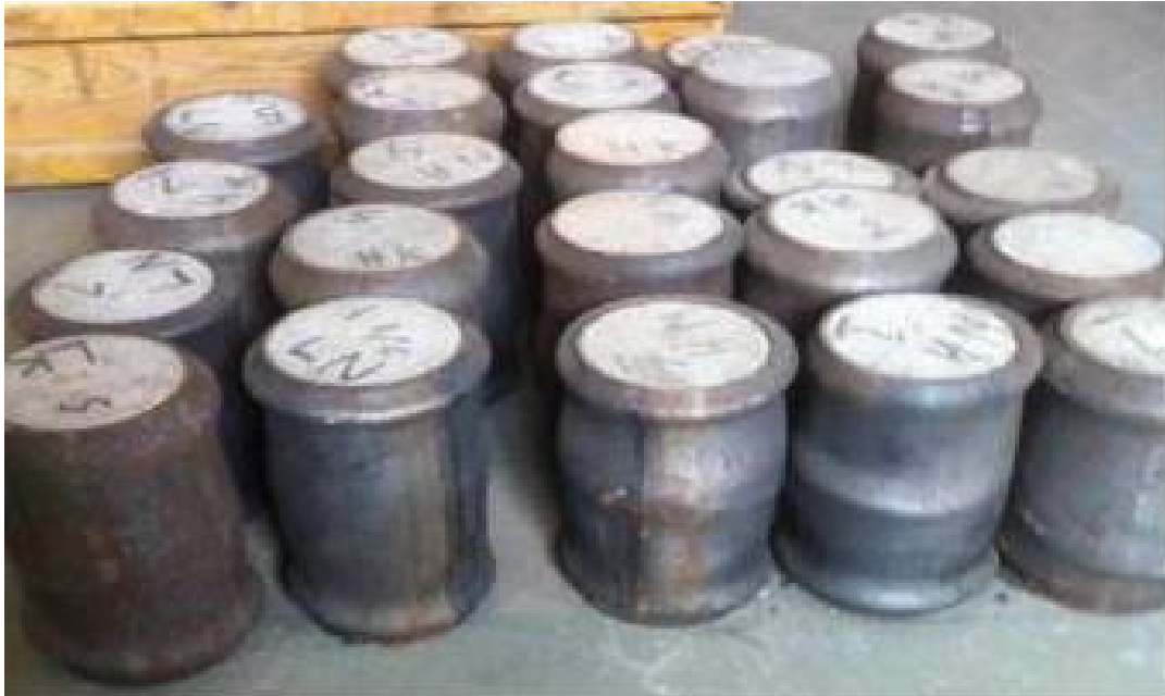
52. ábra –Kísérleti CFST próbatestek tönkremeneteli módja
