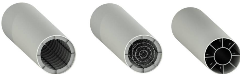
12. ábra – Keresztmetszet tipikus megerősítési módjai
