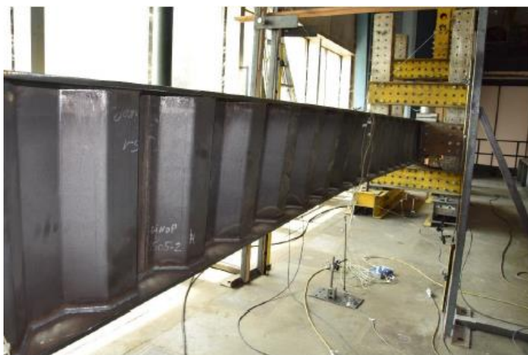
8. ábra: 1/1 próbatest kifordulás vizsgálata (BME – 2019).
