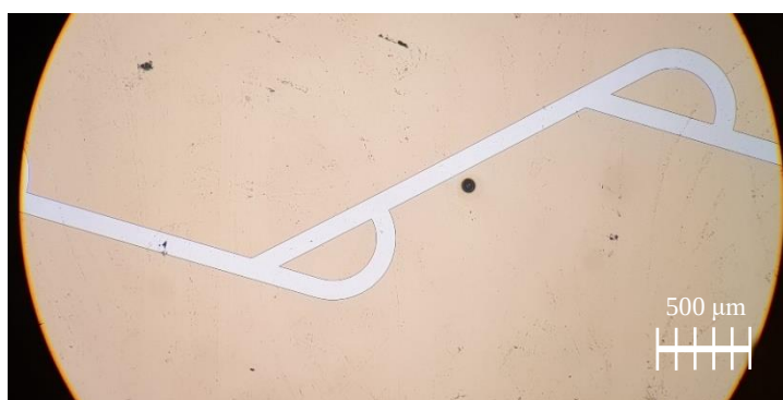
5.1. ábra: Két Tesla-szelep mikroszkóp alatt
