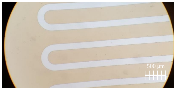
5.2. ábra: A meanderes csatorna mikroszkóp alatt
