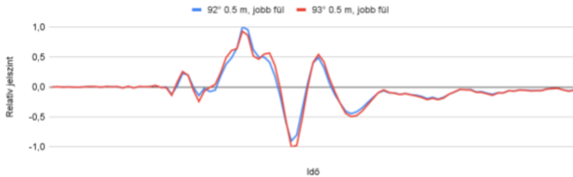
3.4. diagram: Az impulzuscsúcsokra hagyatkozó késleltetésszámítás hibájának oka.
