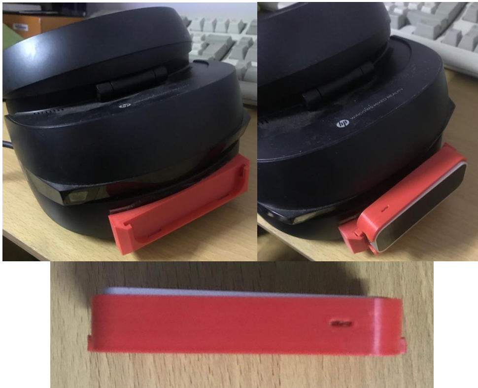
8. ábra: Nyomtatott Leap Motion tartó különböző szögekből.
