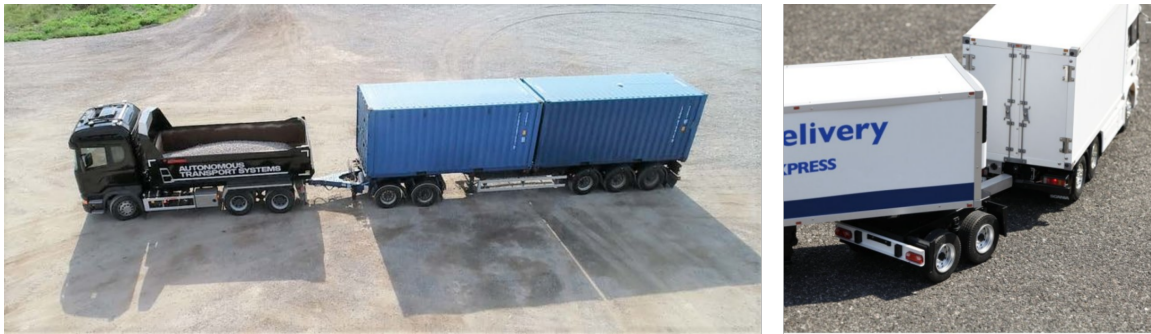
1.3. ábra. Áttekintő kép a vizsgált járműszerelvényről (bal oldal); és a köztes, félpótkocsi a vontató teherautóhoz csatlakoztató elem funkciójának szemléltetése (jobb oldal) (Ljungqvist 2019)
