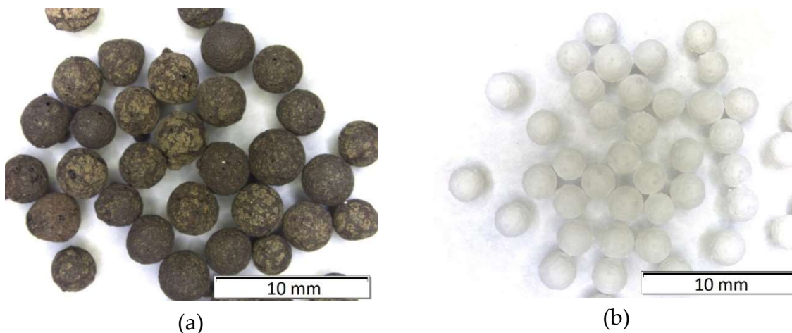
3. ábra: Felhasznált töltőanyagok: (a) duzzasztott agyagkavics, (b) kerámia gömbhéj
