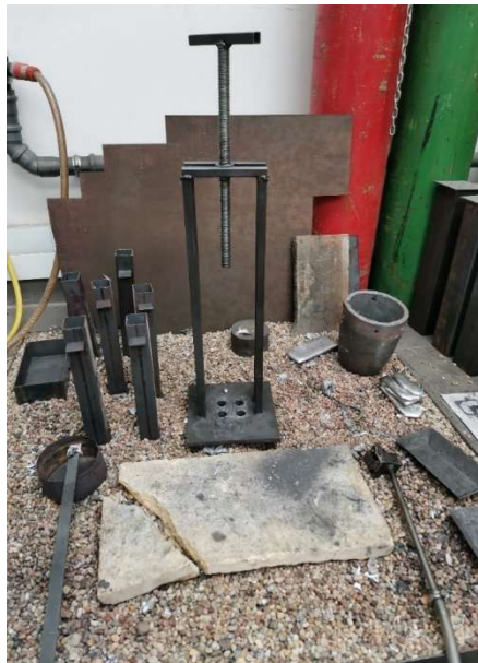
29. ábra: Nyomásos infiltráláshoz használt megfogó keret és az öntéshez szükséges egyéb eszközök
