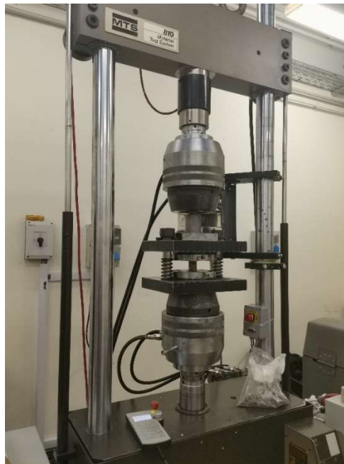
32. ábra: MTS 810 (Material Test System) zömítő berendezés
