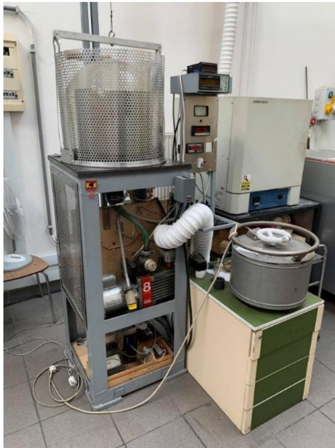
15. ábra: A tanszéki plazmanitridáló berendezés
