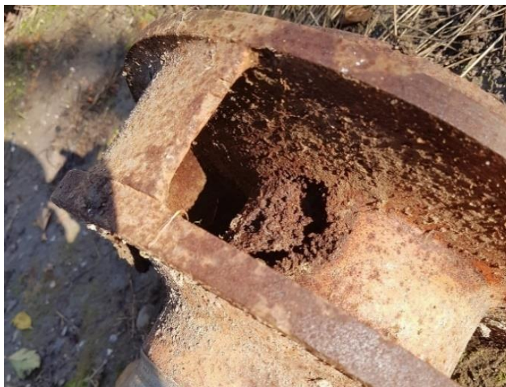
26. ábra: Kavitáció következtében tönkrement járókerék
