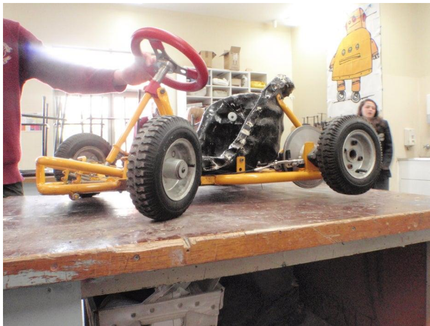
2.10.ábra A gokartokra jellemző kerékelemelés [4]
