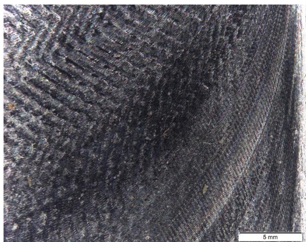
Kép 25: "1/2"-es próbatest ellenirányú marással előállított felületéről készült mikroszkópi kép.
