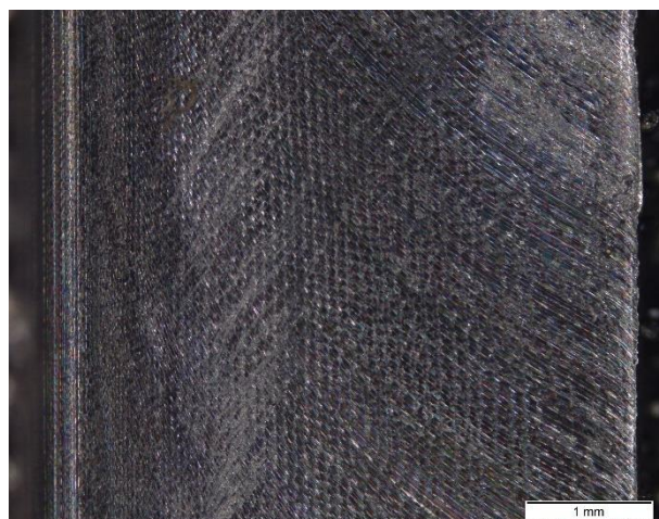
Kép 41: "3/1"-es próbatest egyenirányú marással előállított felületéről készült mikroszkópi kép.
