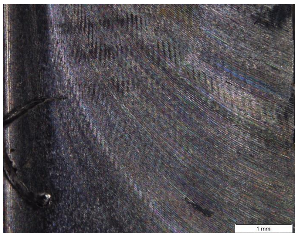
Kép 32: "2/1"-es próbatest egyenirányú irányú marással előállított felületéről készült mikroszkópi kép.
