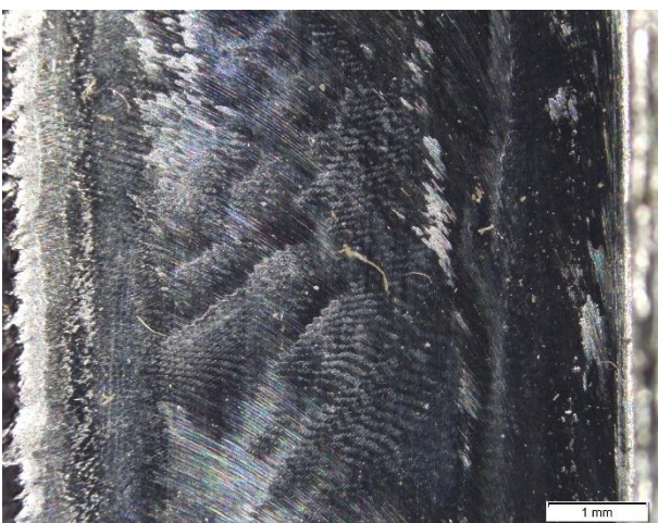
Kép 43: "3/2"-es próbatest ellenirányú marással előállított felületéről készült mikroszkópi kép.
