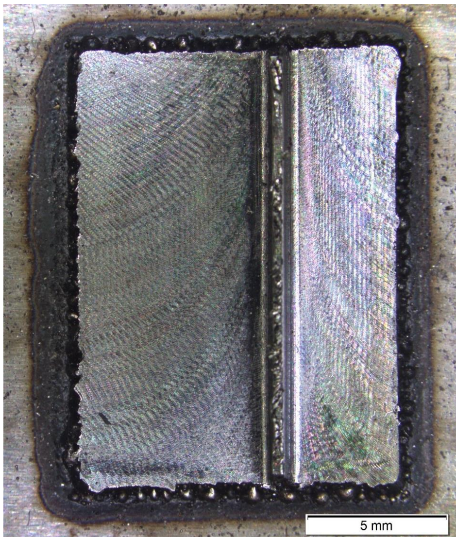
Kép 36: "2/3" - es próba test forgácsolt felületeiről készült mikroszkópi felvétel.
