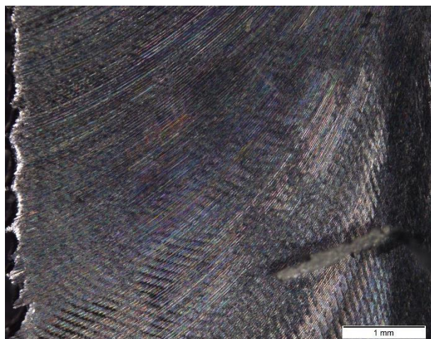
Kép 31: "2/1"-es próbatest ellenirányú marással előállított felületéről készült mikroszkópi kép.
