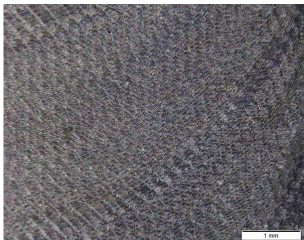
Kép 37: "2/3"-as próbatest ellenirányú marással előállított felületéről készült mikroszkópi kép.
