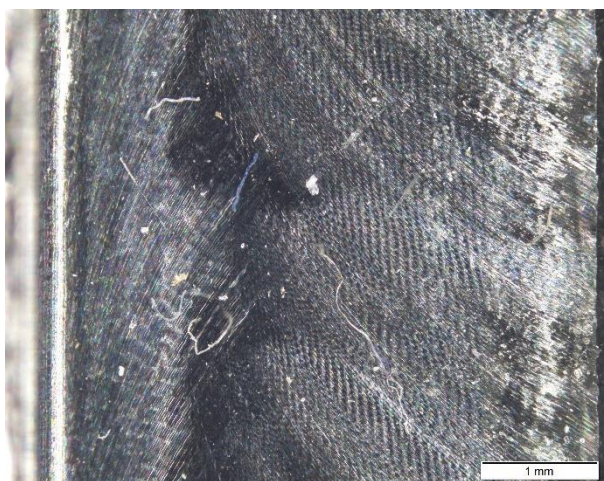
Kép 44: "3/2"-as próbatest egyenirányú irányú marással előállított felületéről készült mikroszkópi kép.
