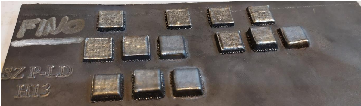
Kép 8: Próba darabok melyek a lézersugár teljesítményének és a lépésköz változtatásával készültek H13-as acélból
