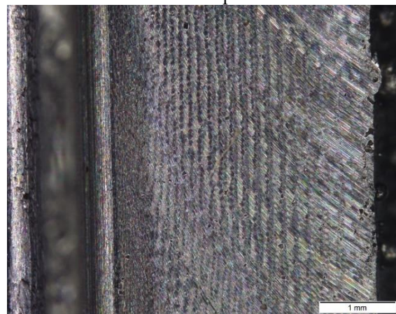
109. Ábra: "2/3"-as próbatest egyenirányú irányú marással előállított felületéről készült mikroszkópi kép.
