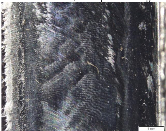
114. Ábra: "3/2"-es próbatest ellenirányú marással előállított felületéről készült mikroszkópi kép.
