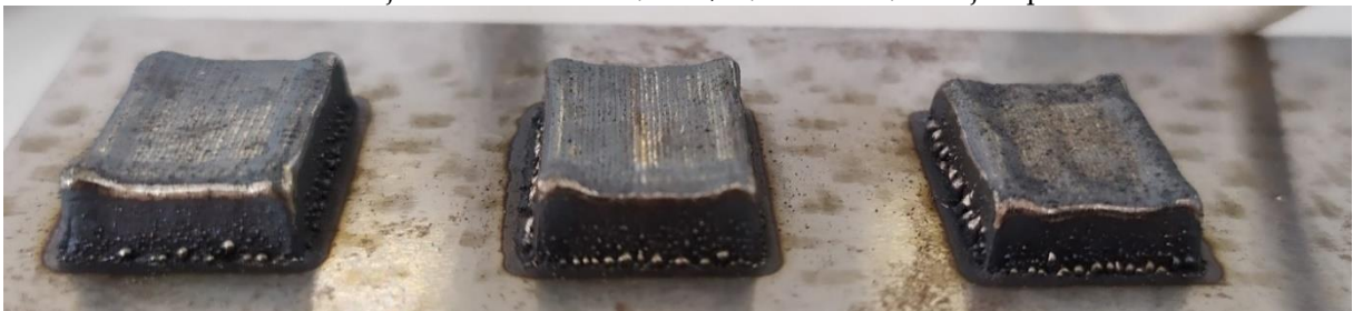
67. Ábra: Balról jobbra rendre az "1/1"-es; "1/2"-es és "1/3"-as jelű próbatestek
