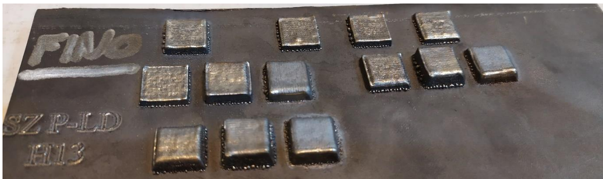
27. Ábra: Próbadarabok, melyek a lézersugár teljesítményének és az átfedés változtatásával készültek H13-as acélból
