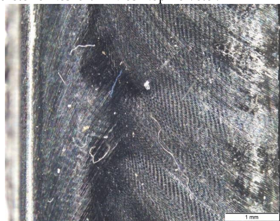
115. Ábra: "3/2"-es próbatest ellenirányú marással előállított felületéről készült mikroszkópi kép.
