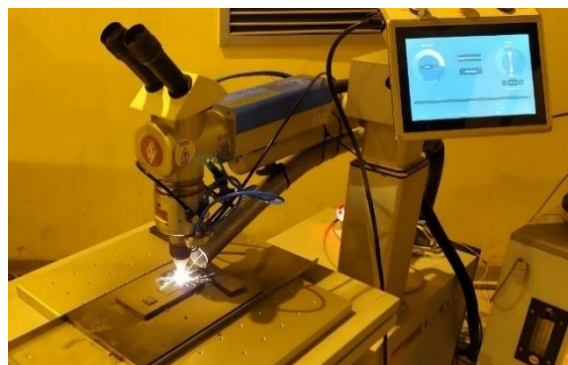
Ábra 23: LRS EVO DiodeLINE típusú lézersugaras hegesztő berendezés [15] (ballra) és üzemküzben a Csepeli Szerszámgépgyár csarnokában (jobbra)
