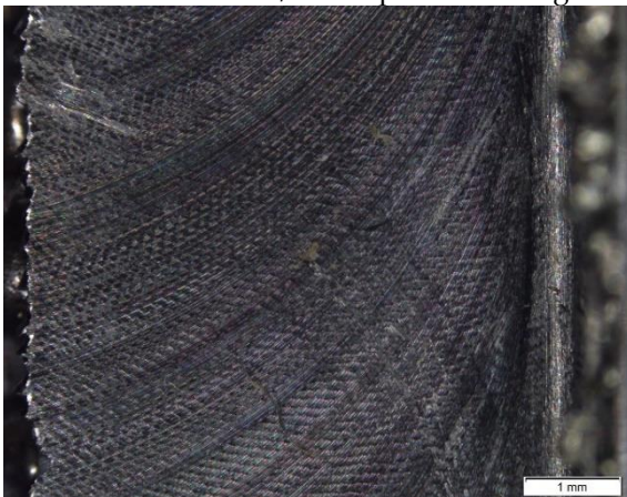
111. Ábra: "3/1"-es próbatest ellenirányú marással előállított felületéről készült mikroszkópi kép.
