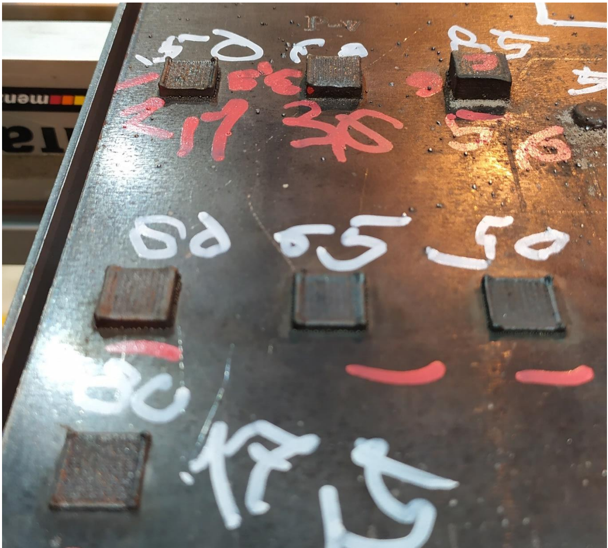
28. Ábra: 15-5PH korrózióálló acél próbatestek, melyek a lézersugár teljesítményének és a pásztázási sebesség változtatásával készülnek
