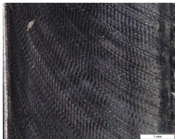
94. Ábra: "1/1"-es próbatest egyenirányú irányú marással előállított felületéről készült mikroszkópi kép
