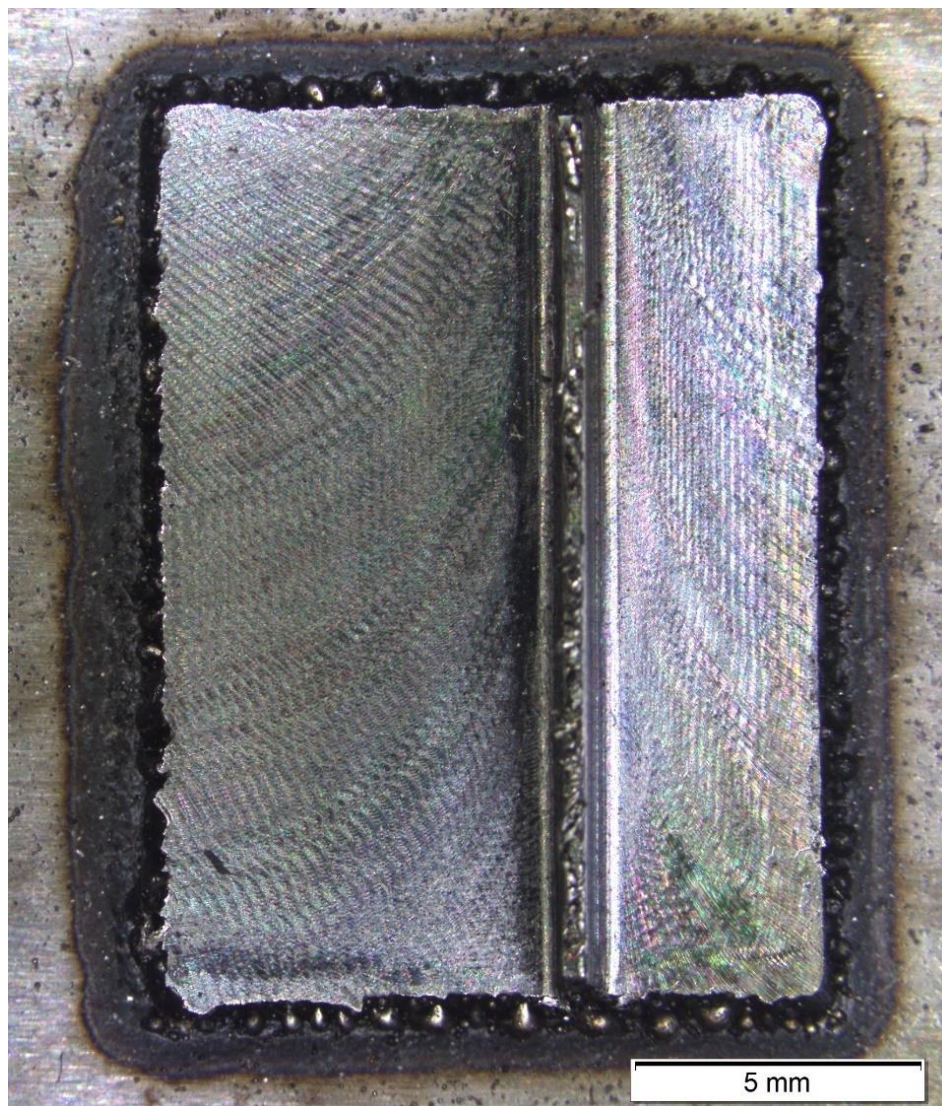
107. Ábra: "2/3"-es próba test forgácsolt felületeiről készült mikroszkópi felvétel.
