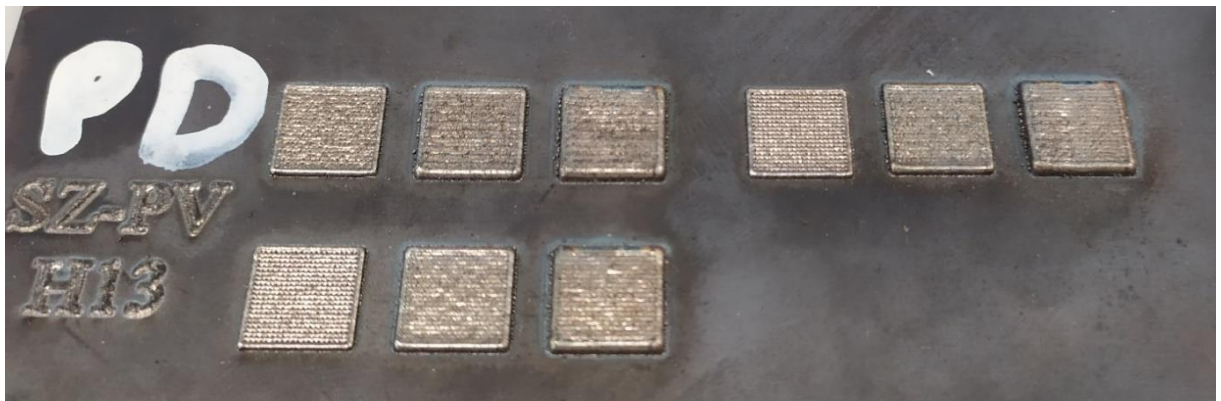
25. Ábra: Próba bevonatolások melyek a Lézersugár teljesítményének és a lézersugár átmérőjének változtatásával készültek.
