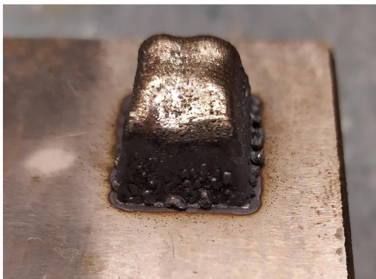
65. Ábra: Elsőként legyártott forgácsoló erők mérésére szánt próbatétel.
