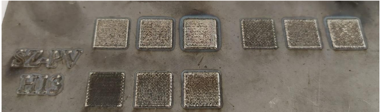
24. Ábra: Próba bevonatolások melyek a Lézersugár teljesítményének és a Hegesztőfej sebességének változtatásával készültek.
