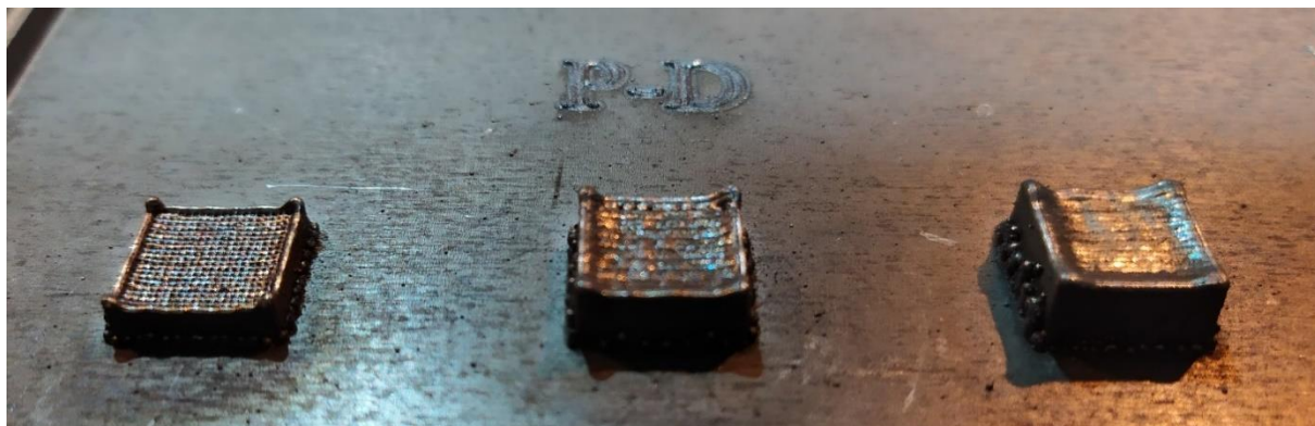
33. Ábra: H13 szerszámacél próbatestek, melyek a lézersugár teljesítményének és a lézersugár átmérőjének változtatásával készülnek
