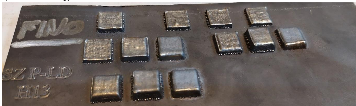
35. Ábra: Mintadarabok, melyek a lézersugár teljesítményének és a átfedés változtatásával készültek H13-as acélból
