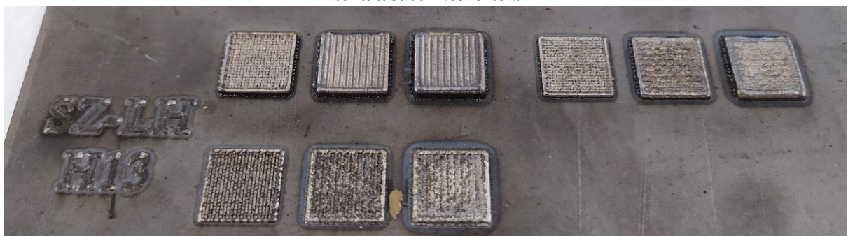
26. Ábra: Próba bevonatolások melyek a Lézersugár teljesítményének és a rétegvastagság átmérőjének változtatásával készültek.
