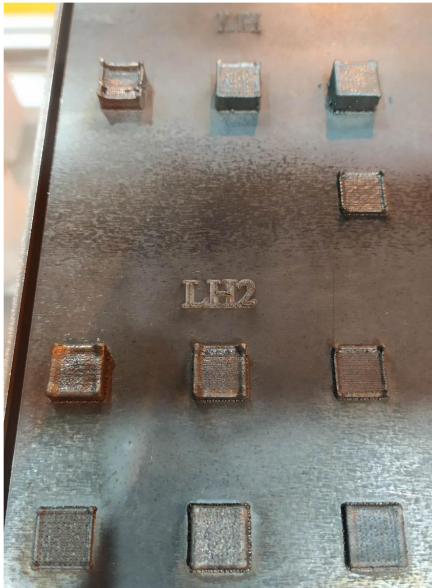
31. Ábra: 15-5PH korrózióálló acél próbatestek, melyek a lézersugár teljesítményének és rétegvastagság változtatásával készülnek
