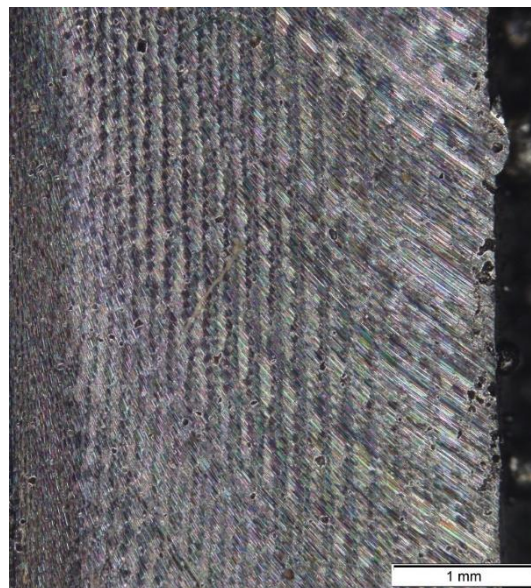
88. Ábra: Magas fokú porozitással rendelkező "2/2"-es próbatest
