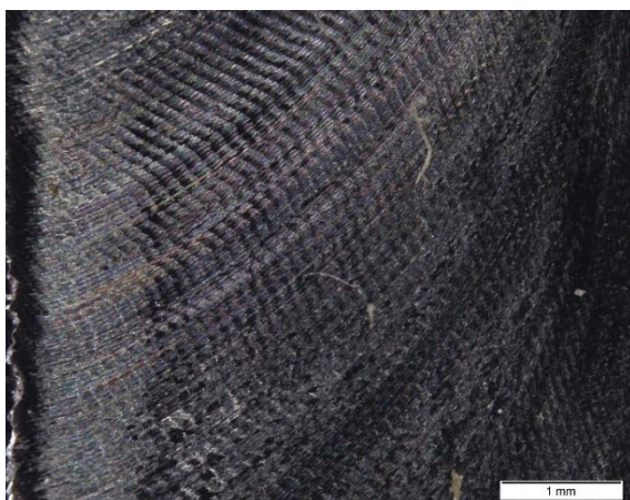
93. Ábra "1/1"-es próbatest ellenirányú marással előállított felületéről készült mikroszkópi kép
