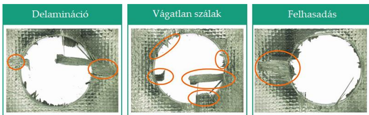
2-1. ábra. A szálerősített polimer (FRP) kompozit anyagok fúrása során keletkező tipikus geometriai hibák [4]
