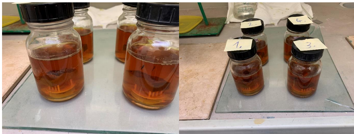
48. ábra A minták elhelyezve a korrodáló folyadékban
