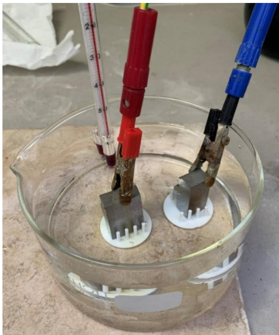
25. ábra Elektrokémiai maratás elrendezése
