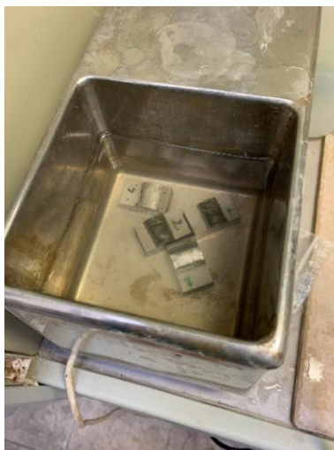
49. ábra A minták elhelyezve az ultrahangos rezegtetőbe
