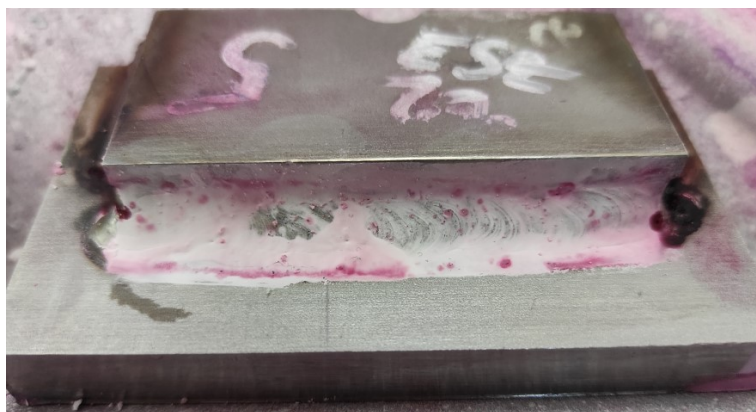
14. Melléklet. Próbatess I. vizsgált varratának penetrációs vizsgálata
