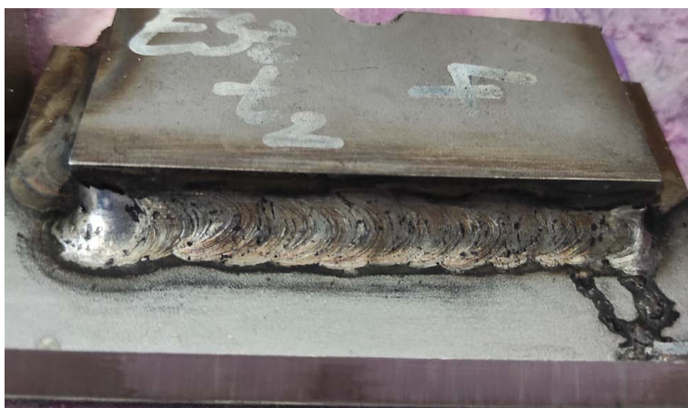
11. Melléklet. Próbatess II. vizsgált varrata
