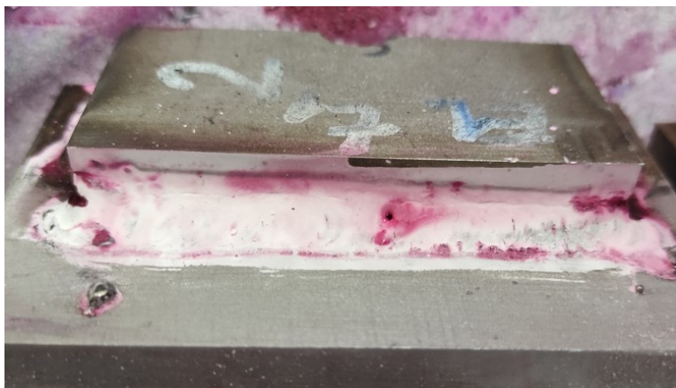
16. Melléklet. Próbatess III. első vizsgált varratának penetrációs vizsgálata
