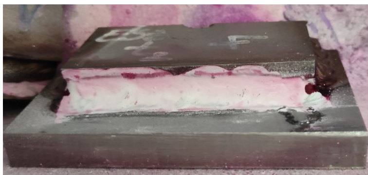
15. Melléklet. Próbatess II. vizsgált varratának penetrációs vizsgálata
