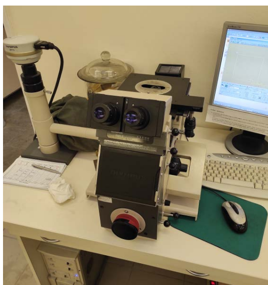
5.8. ábra. Olympus PMG 3 típusú fémmikroszkóp
