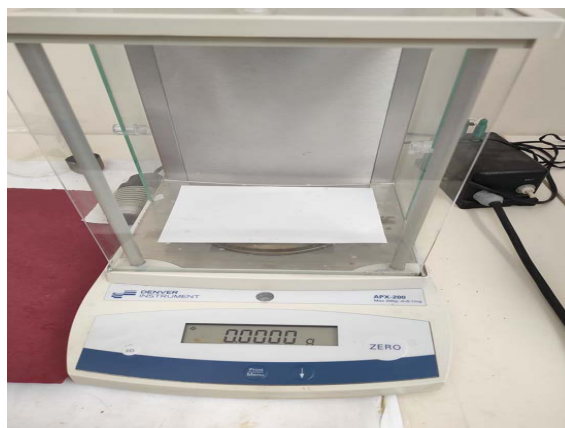
(b) Mérés a Denver Instrument APX-200 típusú 0,1 mg pontosságú mérlegen
