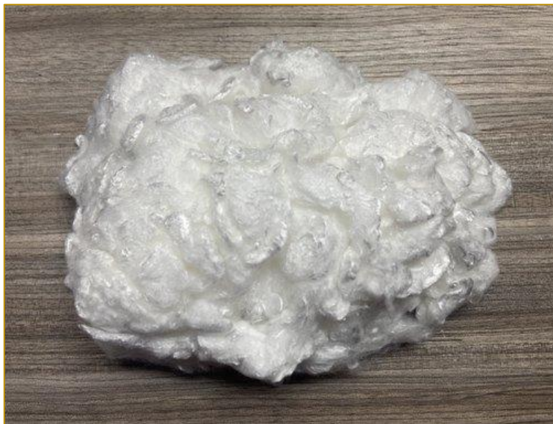
5. ábra A kompozit készítéshez használt VPB-103 típusú PVA szál.
