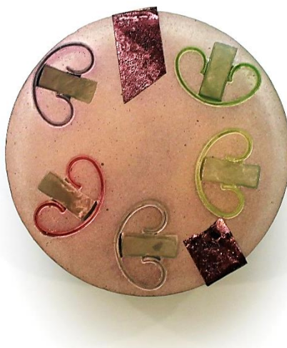
10. ábra Learanyozott, beágyazott próbatestek
