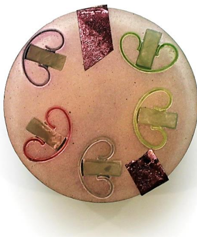
10. ábra Learanyozott, beágyazott próbatestek
