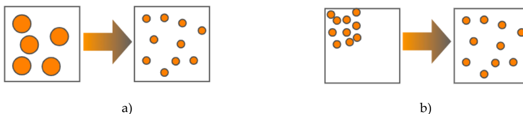
18. ábra Diszperzív (a) és disztributív (b) keverés szemléltetése [12]
