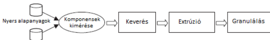
10. ábra Mesterkeverékek előállításának sematikus ábrája [7]
