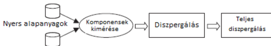
11. ábra Folyadékfestékek előállításának sematikus ábrája [7]
