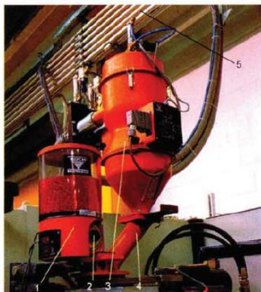
Mesterkeverék adagoló és anyagszállító berendezés keverő nélkül.
