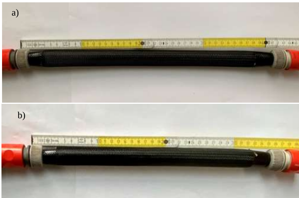
25. ábra A hidraulikus modell vizsgálatához használt eszköz a) terheletlen állapot b) nyomás alá helyezve
