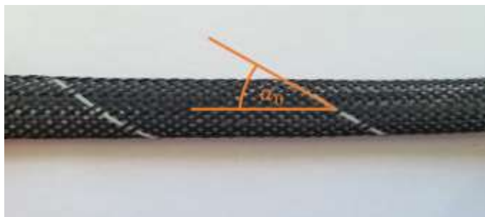
12. ábra - Fonatolási szög. A képen kísérletben használt mesterséges izom fonatolási szöge látható. ( \alpha_0 = 30^\circ )
