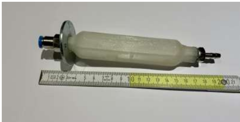
13. ábra A pneumatikus és hidraulikus rendszert csatoló egyedi eszköz.
