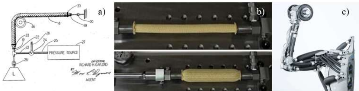
4. ábra McKibben-féle mesterséges izomizom. a) Az eredeti szabadalomban szereplő egyik ábra. Az ábra az aktuátor emelőként való használati lehetőségét mutatja [7], b) Bridgestone által kifejlesztett Rubbertuator nevű McKibben-féle mesterséges izom [8], c) Egy modern alkalmazás: Festo Airic's arm aminek a mozgását McKibben-féle mesterséges izmok végzik [9].
