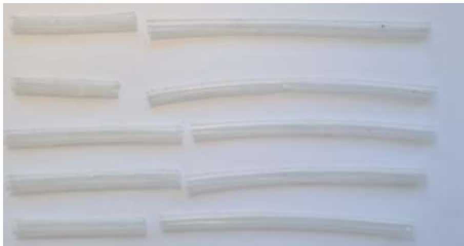
16. ábra szilikon próbatestek szakítás után – A vizsgált darabok visszanyerték áttetszőségüket. A képen látható csövek külső átmérője 8 mm.
