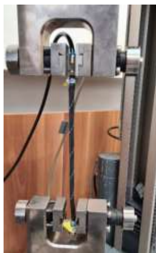
10. ábra - A mesterséges izom szakítógéphez való befogása.
