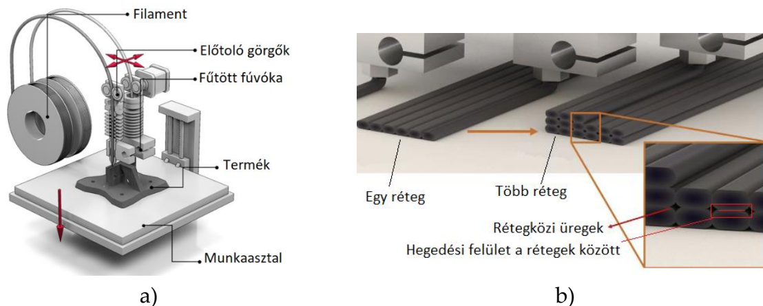
1. ábra a) - Kétfejes FDM nyomtató vázlatos felépítése, b) - Rétegek közötti üregek, rétegek közötti hegedés értelmezése [6]
