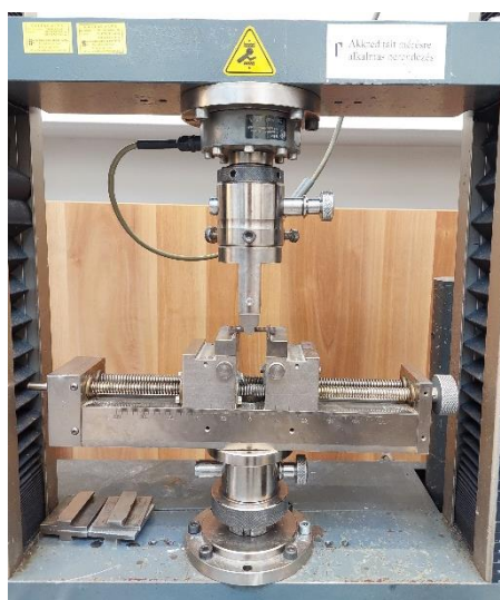
11. ábra A hárompontos hajlítóvizsgálat mérési elrendezése
