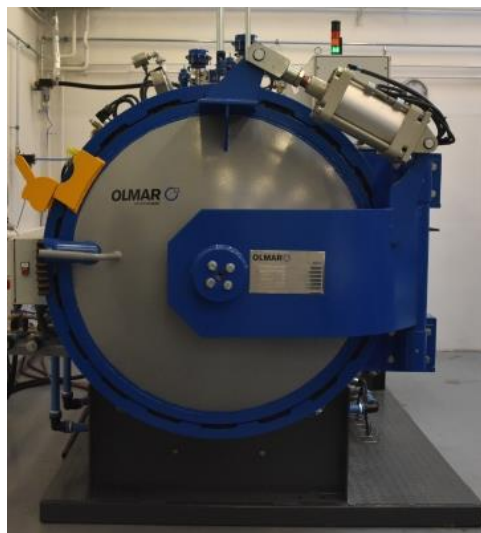
8. ábra A próbagyártásokhoz alkalmazott autokláv, forrás: [39]
