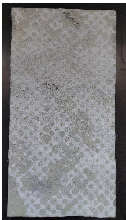
M.4. ábra A 3. gyártáshoz használt, a próbatest felülete mentén elhelyezkedő, gyantát tartalmazó vákuumfilm
