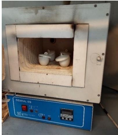
12. ábra Az izzító kemencébe helyezett, mintákat tartalmazó kiégető csészék a kiégetési folyamatot megelőzően
