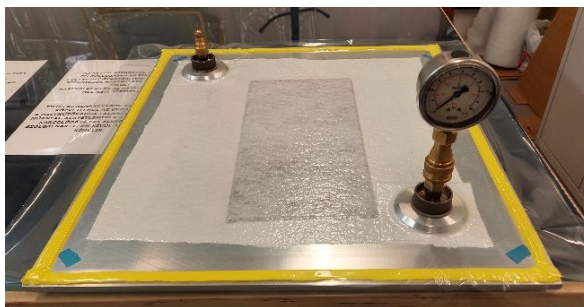
18. ábra A levákuumozott prepreg lemez a zsák ellenőrzése közben
