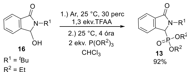
11. ábra: Izoindolinon-foszfónát előállítása 1-hidroxi-izoindolinonból kiindulva
