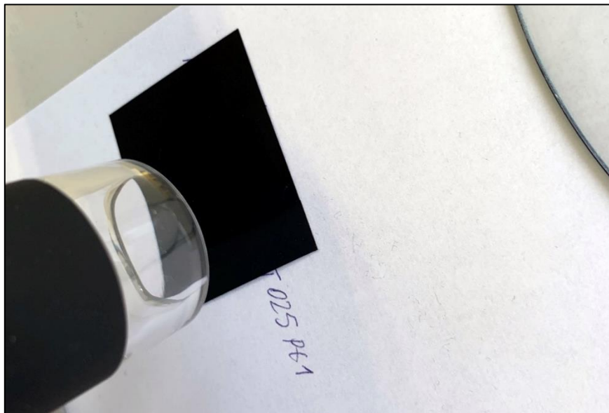
10.ábra: TTK-n használt MEA egység, még Nafion nélkül
