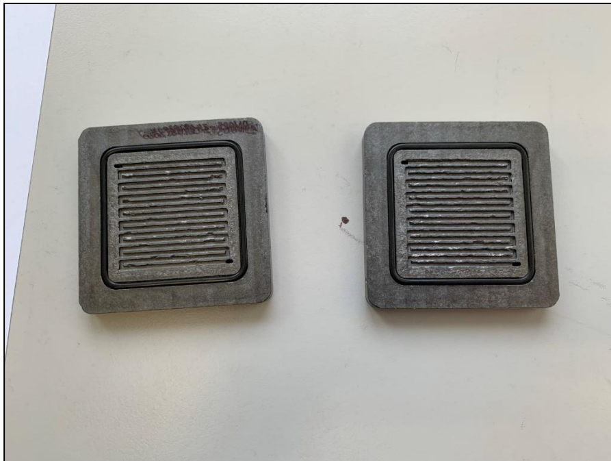
2.ábra: A TTK-n használt tüzelőanyag-cella bipoláris lemezének kialakítása
