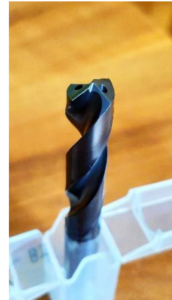
28.ábra – A kísérlethez használt kétélű fúró [62]
