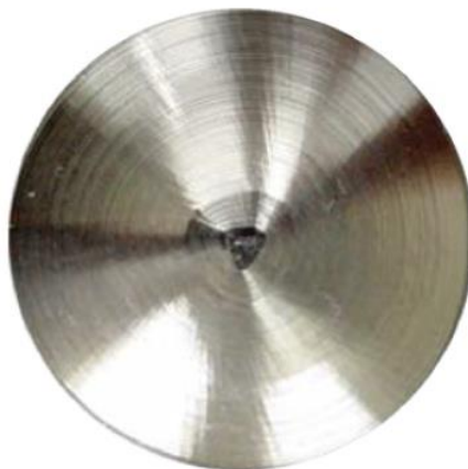
12.ábra. Örvénylő rezgés okozta furattorzulás [45]
