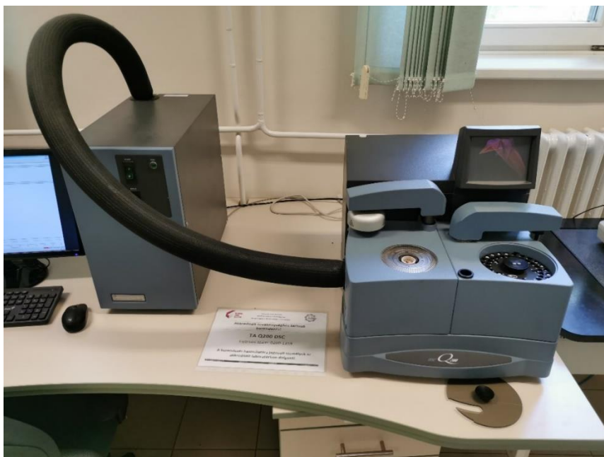
9. ábra: Neumann János Egyetem Innovatív Járművek és Anyagok tanszéken található TA DSC Q200 típusú mérőberendezés
