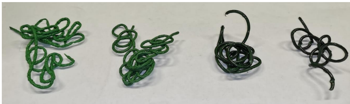
8. ábra: Poliamid 6 alapú szén nanocső nanokompozitok 0; 0,2; 0,4; 0,6 % szén nanocső tartalom
