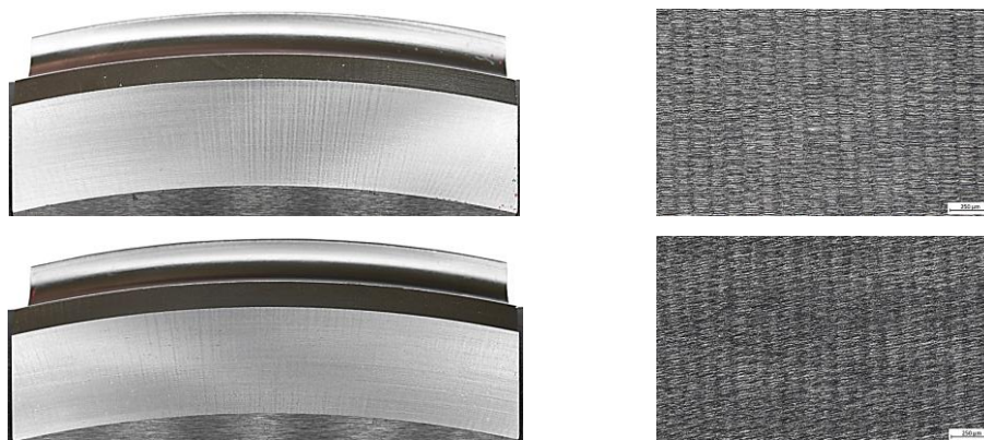
30. ábra: A „C” tengely 180°-os forgatásának hatása a felület minőségére
