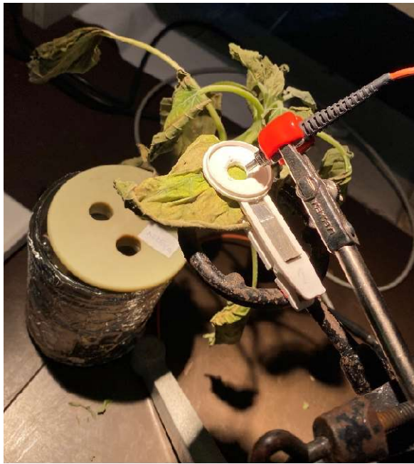
7-8. kép: A reflektancia mérés folyamata, jobb oldalt az aktuális növény (N150-es növény PEG100-as beállításban) reflektancia görbéje látható. (saját fotó)
