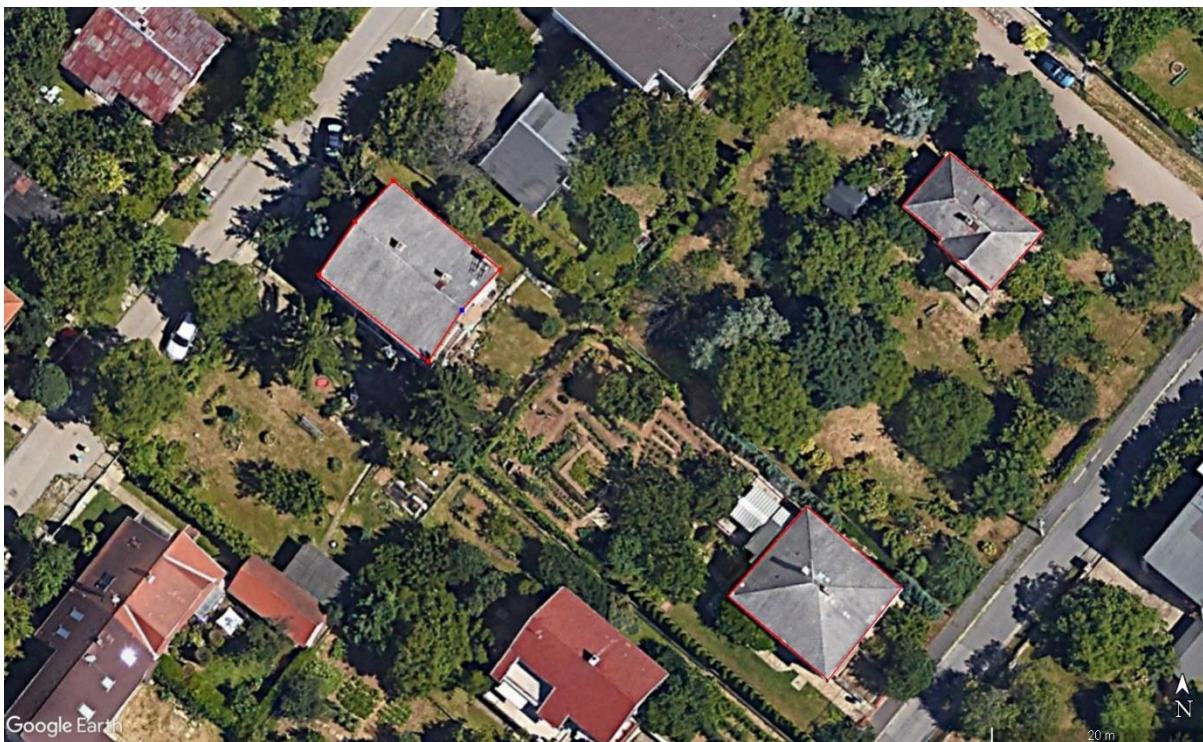
8. ábra Google Earth szoftveren belül készített azbesztet jelölő poligon
