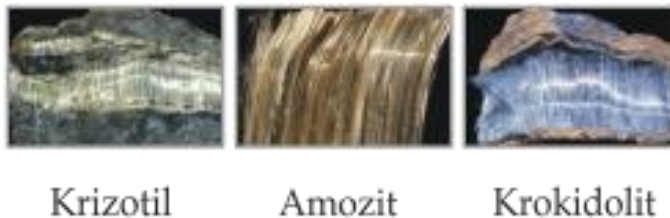
1.ábra: A főbb azbeszt típusok (forrás: [2.])
