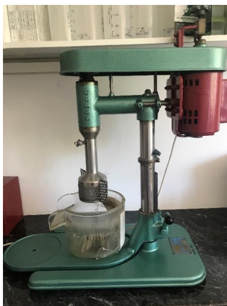
6. ábra: 3 literes flotáló berendezés (Forrás: saját fénykép)
