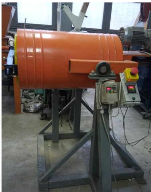
3. ábra. Laboratóriumi dobmalom (Forrás: Mucsi és Rácz, 2021)
