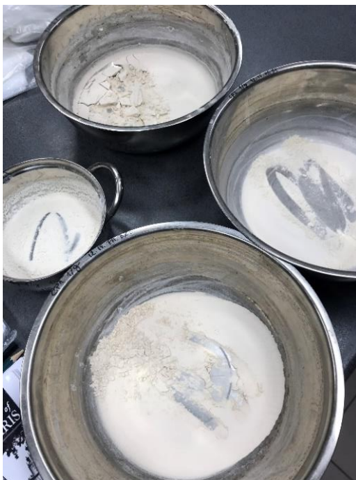
10. ábra: 10 perces golyós őrlés, 1 literes flotálás 4 terméke flotálás és szárítás után (Forrás: saját fénykép)
