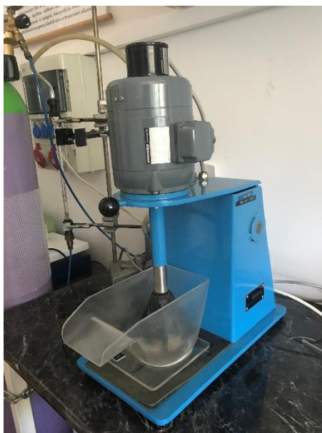
5. ábra: 1 literes flotáló berendezés (Forrás: saját fénykép)
