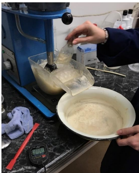
7. ábra: Az 1 literes flotáló cella flotálás közben (Forrás: saját fénykép)
