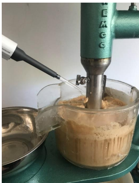
8. ábra: A 3 literes flotáló berendezés reagens adagolása, azaz kondicionálás közben (Forrás: saját fénykép)
