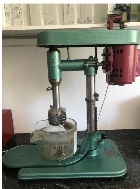
3. ábra: 1 literes flotáló berendezés (Forrás: saját fénykép)
