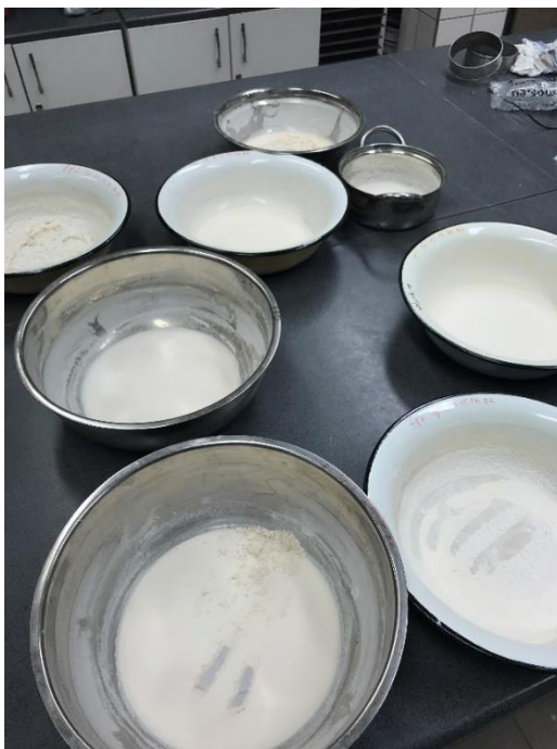
12. ábra: Flotálási termékek szárítás utáni állapotban (Forrás: saját fénykép)
