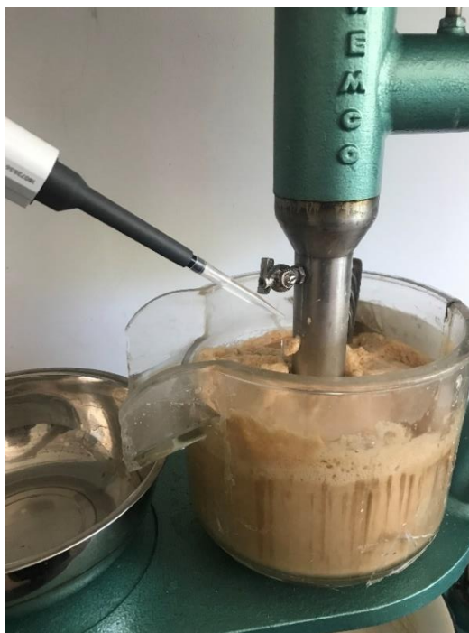
6. ábra: A 3 literes flotáló berendezés reagens adagolása, azaz kondicionálás közben (Forrás: saját fénykép)
