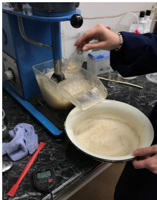
5. ábra: Az 1 literes flotáló cella flotálás közben (Forrás: saját fénykép)
