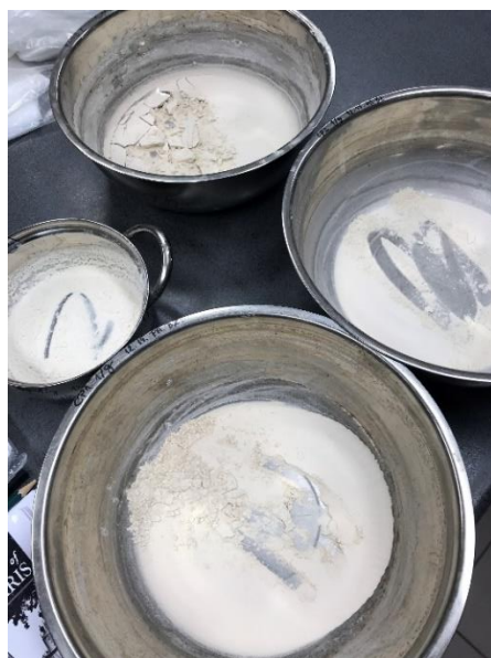
8. ábra: 10 perces golyós őrlés, 1 literes flotálás 4 terméke flotálás és szárítás után (Forrás: saját fénykép)
