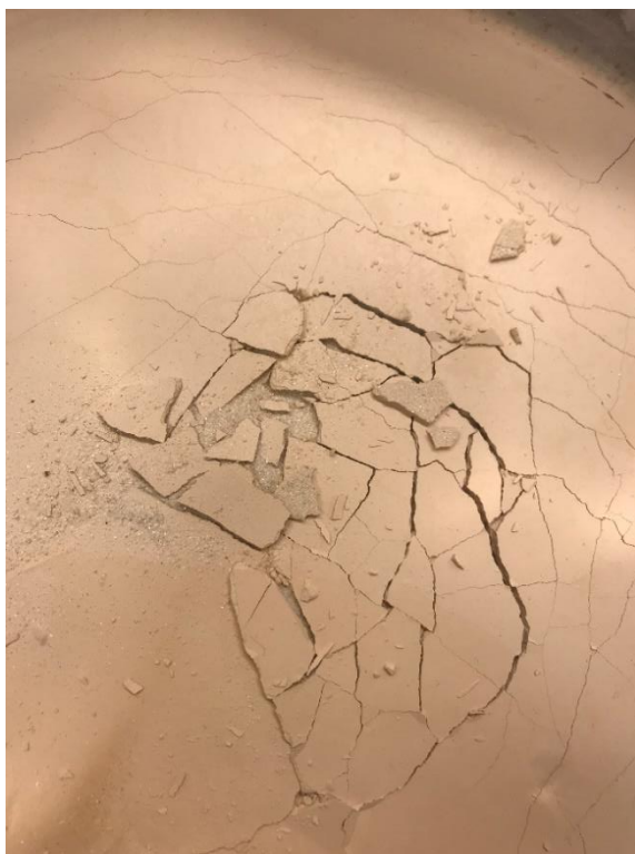
13. ábra: Első cellamaradék szárítás után (Forrás: saját fénykép)
