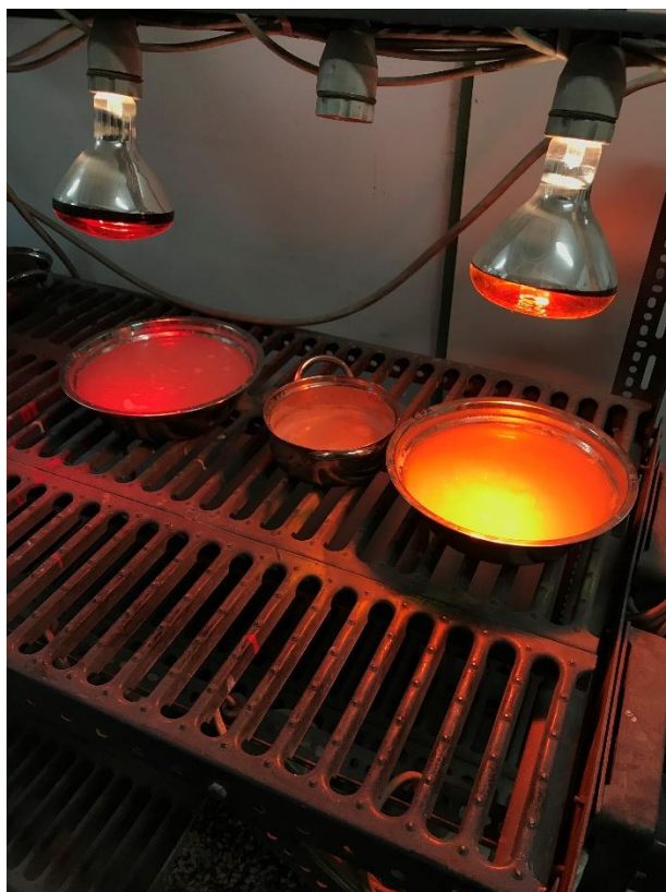
11. ábra: Flotálási termékek infralámpa alatt (Forrás: saját fénykép)
