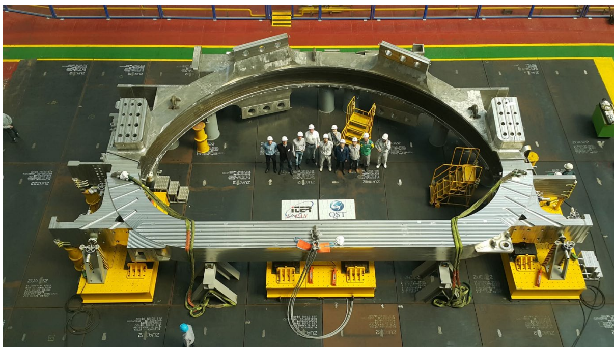
8. ábra: Az ITER egyik toroidális tekercsének acél burkolata, 2018 május [3].
