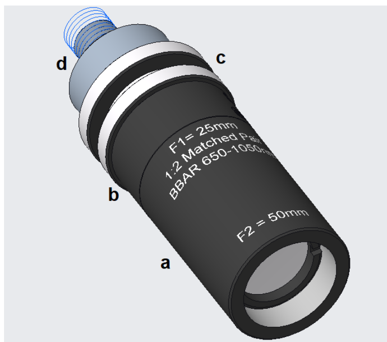
14. ábra. Detektorba csatlakozó optikai szálhoz tartozó leképező optika modellje
