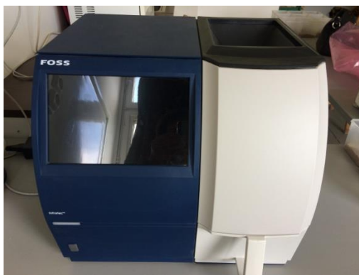
7. ábra FOSS Infratec beltartalom elemző műszer
