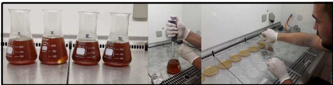
12. ábra: Sorozathígítási mérgezett agarlemez elkészítése (Fotó: Petróczy Marietta, 2021)
