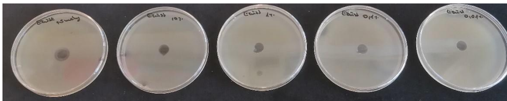
27. ábra: Ezüst kolloid antibakteriális hatásának kimutatása gátlási zóna alapján a különböző hígításokban (Fotó: Forgács, 2021)
