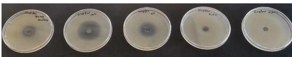
23. ábra: Kupfer Fusilan WG antibakteriális hatásának kimutatása gátlási zóna alapján a különböző hígításokban (Fotó: Forgács, 2021)
