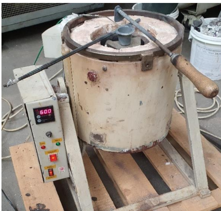
5. ábra: Kísérlet során alkalmazott ellenállás fűtésű kemence és fekecselt segédesszközök
