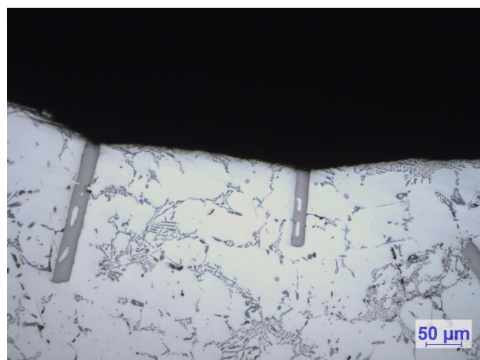
23. ábra: Olvadék felületi oxidhártáján csíráképződött (Al,Si)_3Ti fázisok
