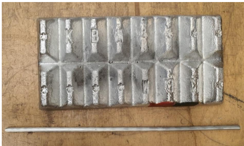
1. ábra: Al-10%Ti (felső) és Al-5%Ti-1%B (alsó) előötvözetek
