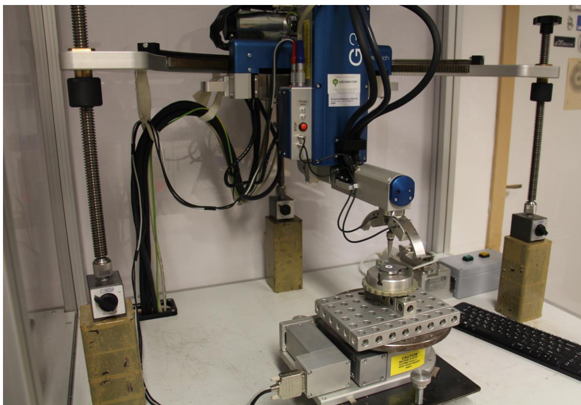
A próbatest a G3R központ nélküli röntgendiffraktométer alatt.
