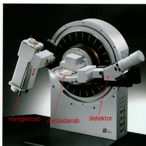
6. ábra Diffraktométer tipikus felépítése és alumínium por diffraktogramja Co röntgensővel meghatározva[13]
