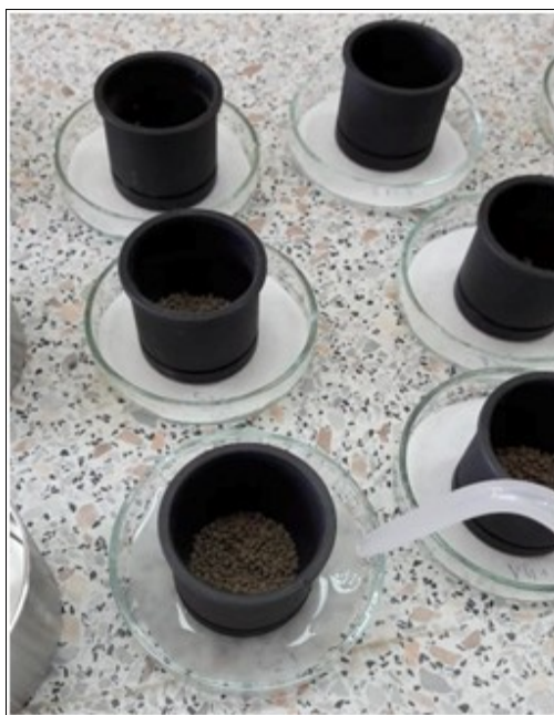
5. ábra: A minták előnedvesítése kapilláris úton (Fotó: Labancz V., 2021)
