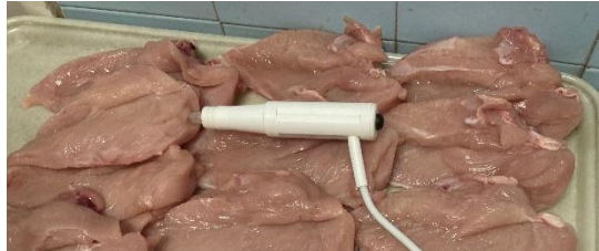
8. ábra: pH-mérés HI 99163 pH-mérő műszerrel (Kiss 2021)
