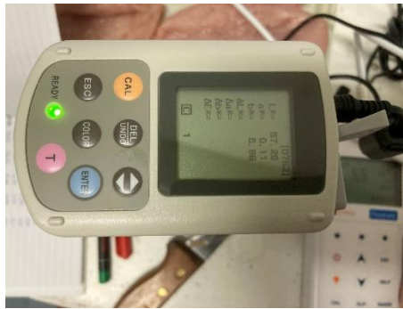
7. ábra: Hússzín mérése Konica Minolta kromaméterrel (Kiss 2021)
