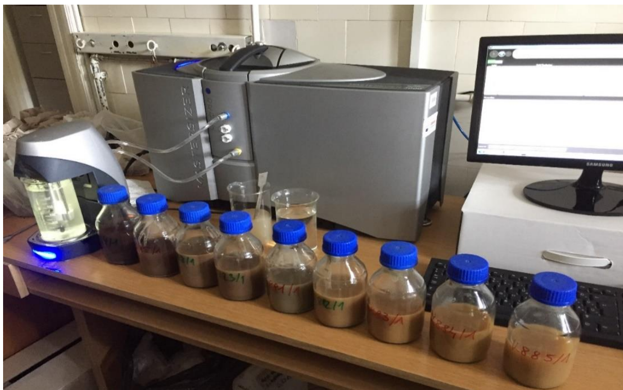
14. ábra Talajminták frakcióinak meghatározása Malvern Mastersizer 3000 lézerdiffrakciós készülékkel
