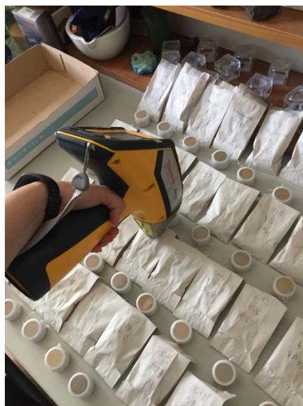
15. ábra Talajminták összes nehézfémtartalom mérése kézi XRF készülékkel
