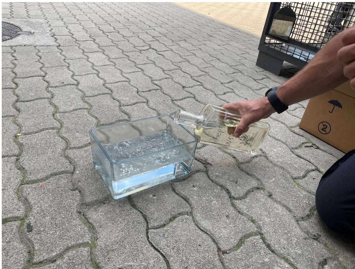
5. kép N- heptán töltése vízbe üvegtárában
